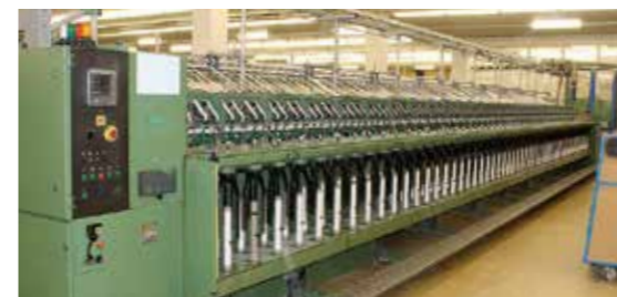
Die modernen Maschinen, wie hier der Flyer, signalisieren mit Warnlichtern, wenn Hilfe nötig ist.
