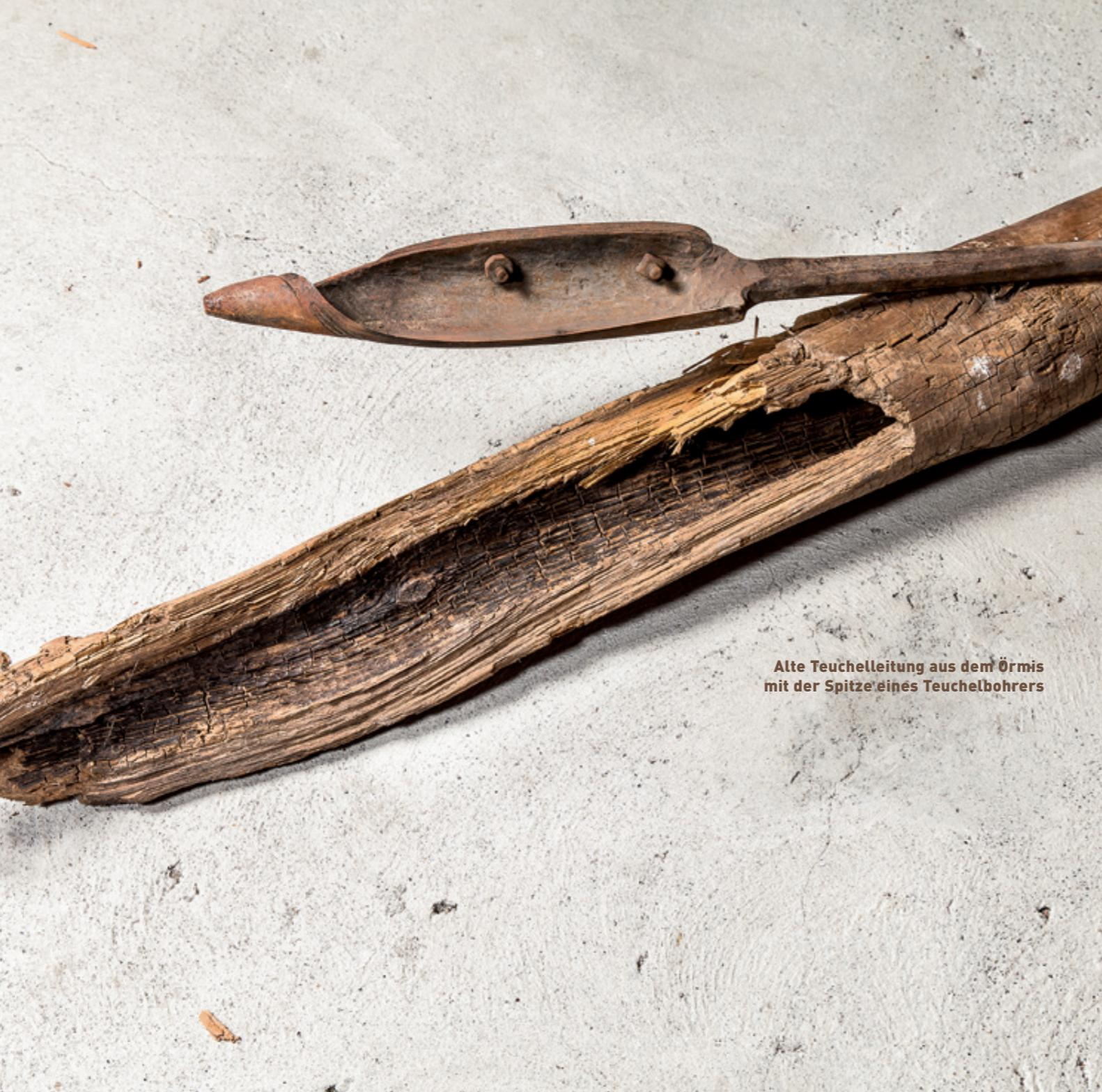
**Alte Teuchelleitung aus dem Örmis mit der Spitze eines Teuchelbohrers**
